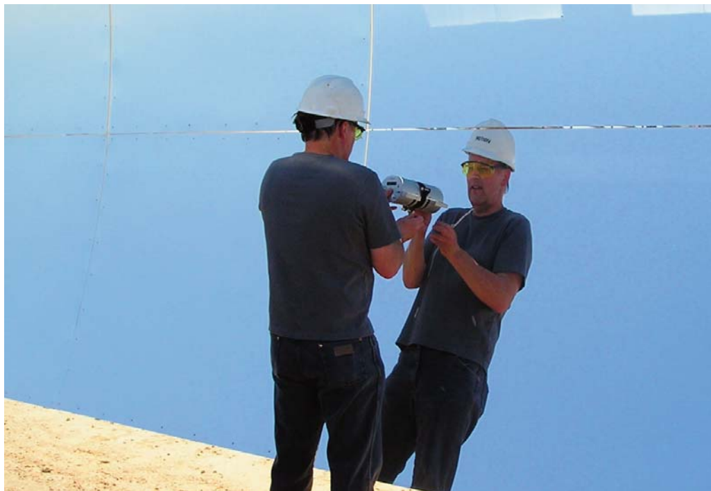
Randy Gee, co-inventor de la película reflectante ReflecTech®, midiendo la reflectancia de la película a SEGS VI.
