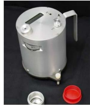
**Fig. 2. Specular Reflectometer**
